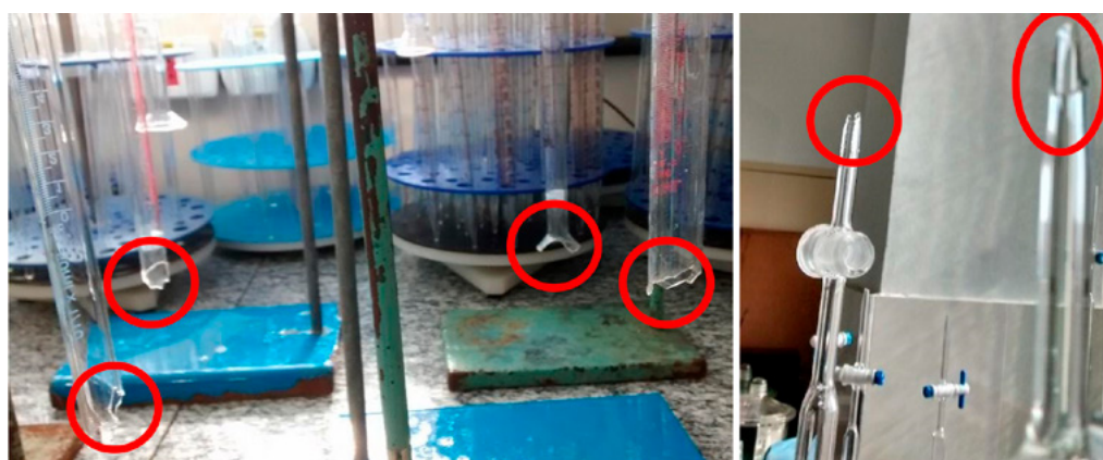
Figura 25 Exemplos de vidrarias quebradas que necessitam de reparo no Campus Rio de Janeiro.
